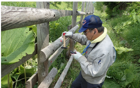
【木製構造物診断の様子（マニュアルより）】
