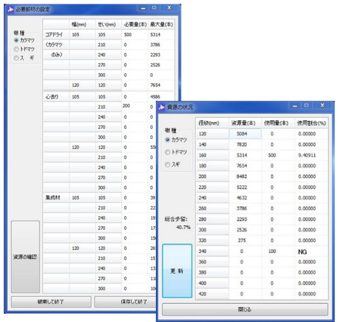
図9 必要部材の設定画面（左）と指定地域の資源の状況（右）の表示画面
