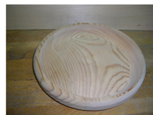
図 2-11-19 凹面加工を付与した CNC 木工旋盤で加工した福祉食器
