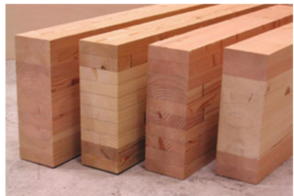
図 2-9-4 道産材を用いた異樹種複合集成材
