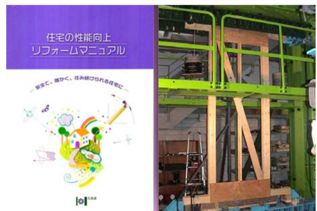
図 2-1-3 講習会で使用したマニュアル(左)と耐震性能評価実験状況(右)
