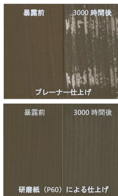
図 2-2-14 促進耐候処理による外観の変化
