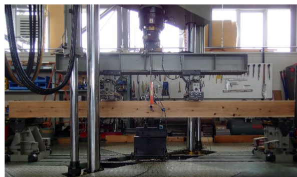
図 2-1-9 道南スギ大径材の曲げ試験
