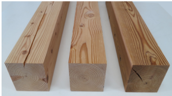
高温処理が不十分 (表面割れ) コアドライ 過度な高温処理 (内部割れ)
