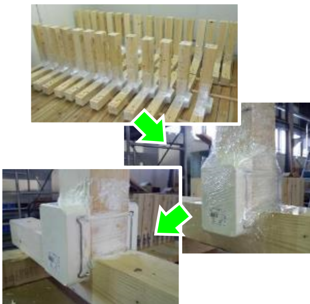
図 2-2-4 実大構造材の強制腐朽試験
