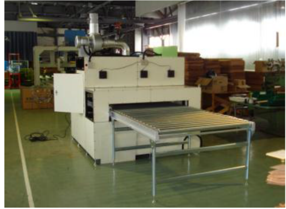
図 2-11-24 節脱落防止処理装置全景
