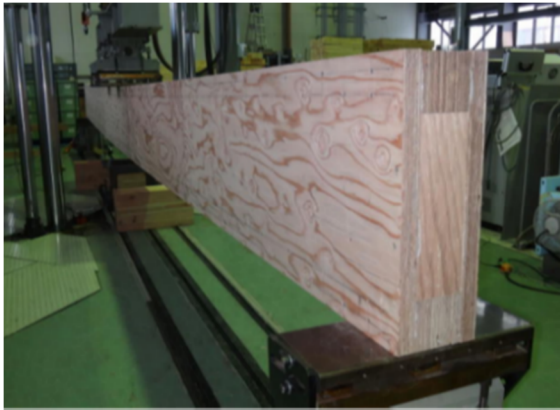
図 2-9-5 道産カラマツ箱形梁の強度試験
