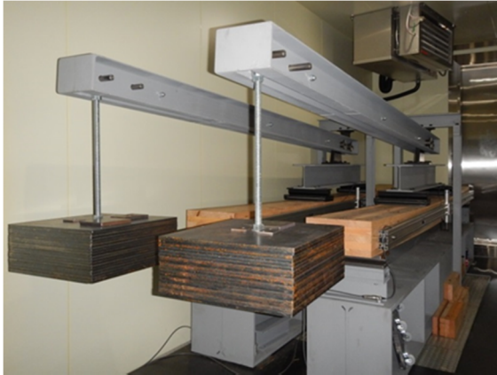
図 2-9-14 CLT の長期荷重試験
