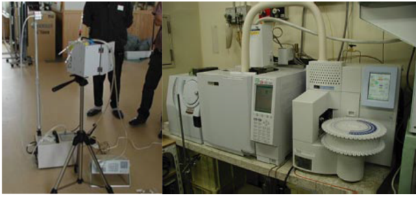
図 2-3-2 シックスクール調査事例 (左：室内空气中化学物質の捕集、右：機器による化学物質の分析)
