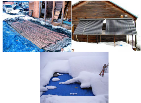
図 2-11-16 消融雪回路システムによる融雪効果試験
