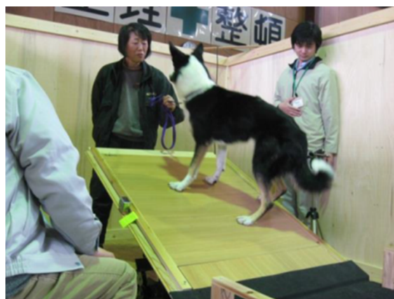
図 2-11-4 木質床の犬による傾斜法試験の様子
