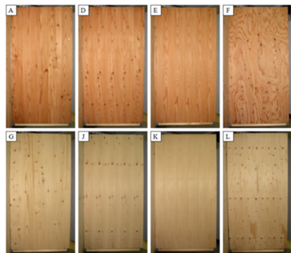
図 2-8-1 官能試験に供した内装用道産針葉樹合板 (上:カラマツ、下:トドマツ)
