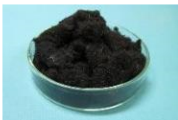
図 2-6-8 低温熱処理物 上：チップ状、下：繊維状
