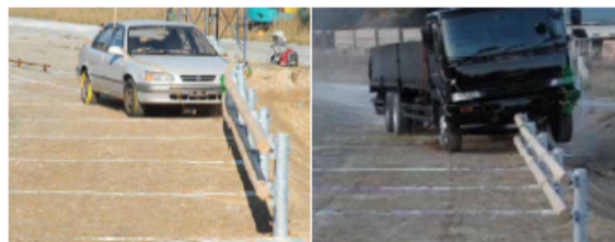
図 2-11-9 木製ガードレールの実車衝突試験
