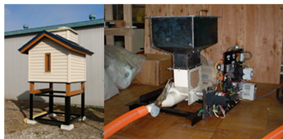
図 2-11-23 ペレットの貯蔵庫（左）と自動供給装置（右）
