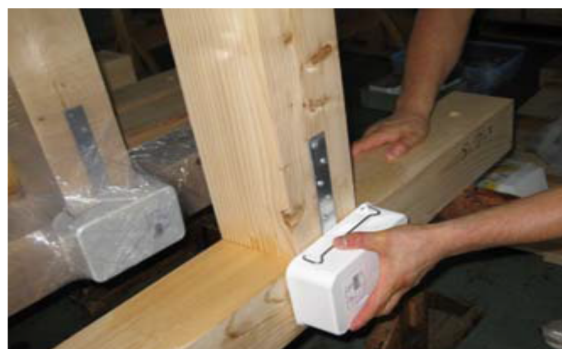
図 2-1-6 腐朽源ユニットと腐朽処理の様相
