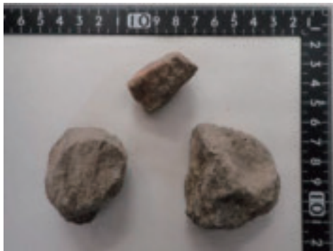
写真 3-2-3-(3)-4 燃料内に混入した異物
