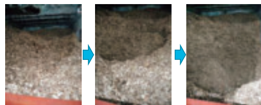
写真 3-2-3-(1)-9 木チップのアジテータへの供給状況
