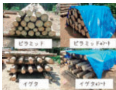
写真3-2-2-2 丸太乾燥試験の設置状況
