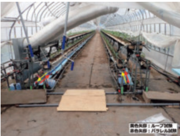
図4-2-5-2 ハウス室温昇温試験の配管敷設状況
