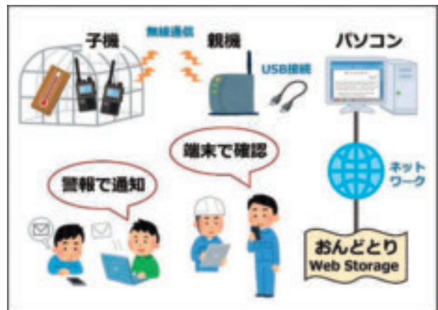
図4-2-5-10 「おんどとり」及び「おんどとり Web Storage」を用いた見える化の運用イメージ
