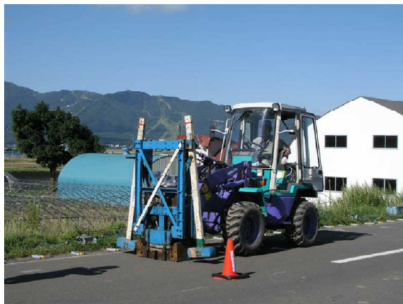
活断層の構造を探る 反射法地震探査の人工震源(富良野断層帯)
