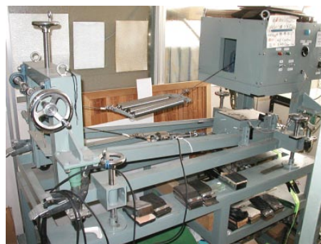
写真1 床の滑り試験機の外観
