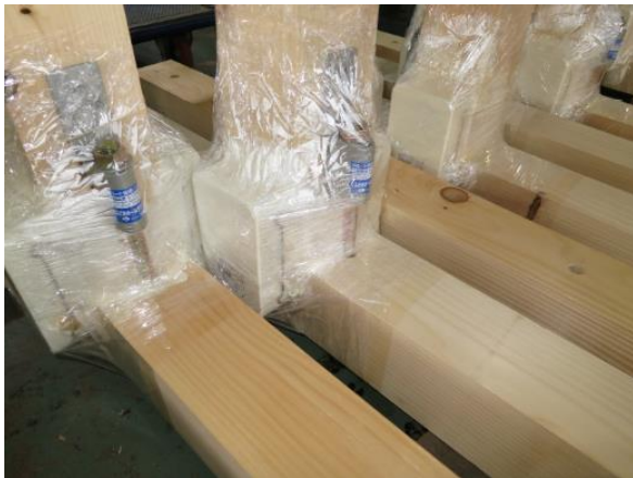
第2図 腐朽処理中の試験体の様子
