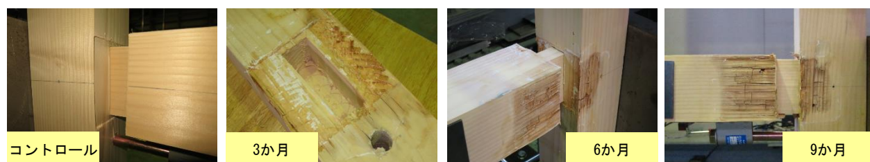
第6図 引張圧縮加力試験終了後の土台材のめり込みの様子
