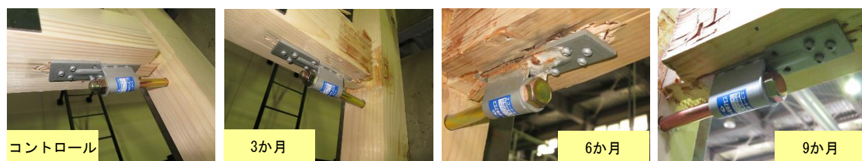
第5図 試験終了後の金物接合部の様子
