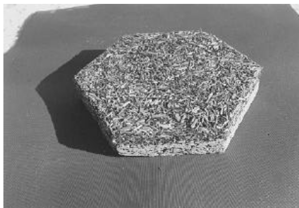
第3図 試作した舗装資材(2層タイプ) Fig. 3. The flagging made experimentally (two layer type).
