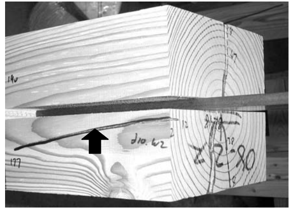
第2図 ドリフトピンに直交する割れ Fig. 2. A check extends perpendicular to the drift pin.
