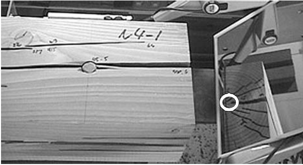
第5図 破壊の進行状況（割裂発生時）
