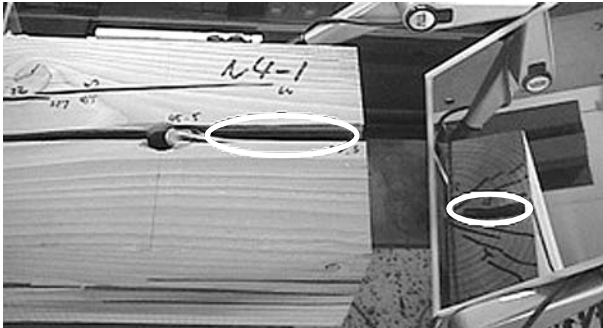
第6図 破壊の進行状況（最大荷重時）
