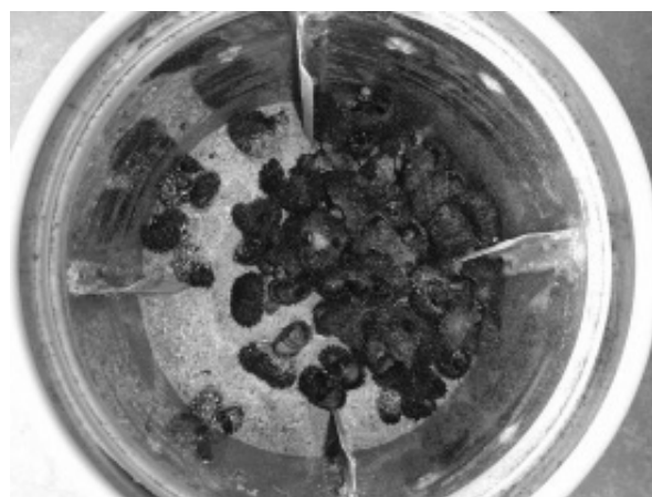
第5図 処理前および2日間処理後のウニ殻と木粉
