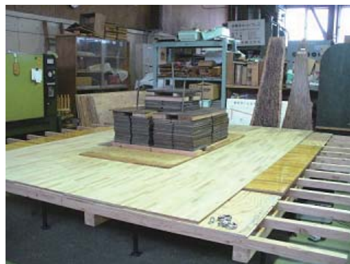
第 11 図 鉛直載荷試験 Fig. 11. Test of vertical loading on floor.
