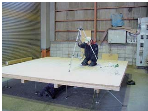
第 10 図 床の転倒衝突時硬さ試験 Fig. 10. Test of floor hardness at collision.
