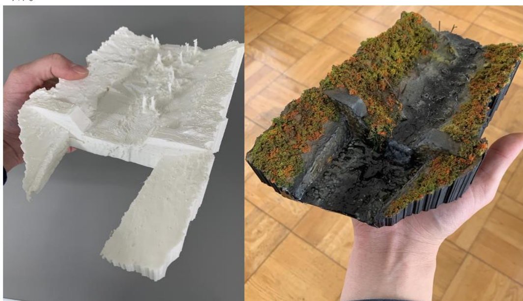
写真-1 iPad LiDAR の 3D データにより作成した 3D 模型(左)と、加工した模型(右)
