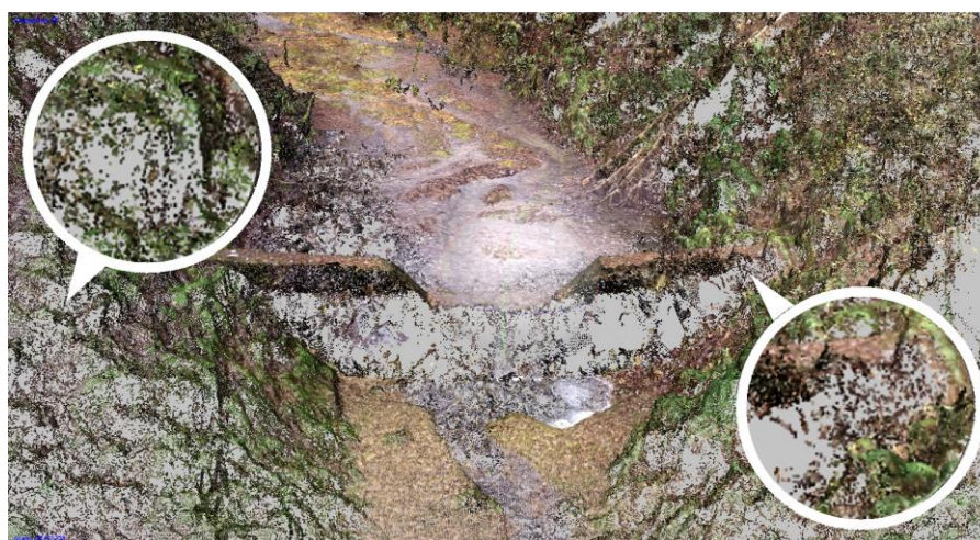
図-1 3D点群データ化された治山ダム。無数にある点のそれぞれに対して、色情報・3次元位置座標などが付与され、様々な情報が抽出できる。
