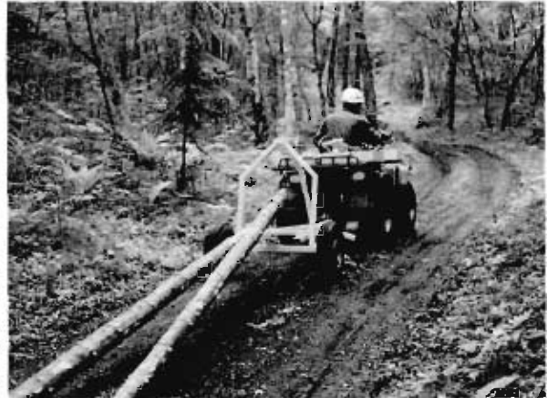
写真-5 全幹作業システムにおける集材作業
