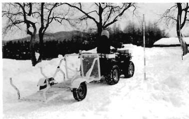
写真-3 積雪路における登坂走行試験の様子
