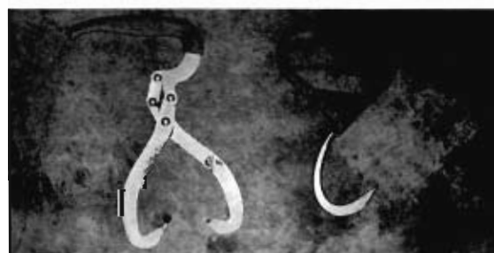
写真-10 短幹材の積込み、荷おろしに使用されるトング(左側)とフック
