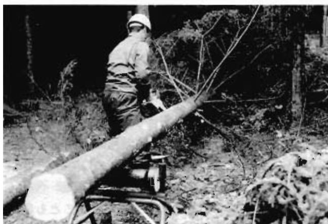
写真-7 ローラベンチを使った枝払い作業
