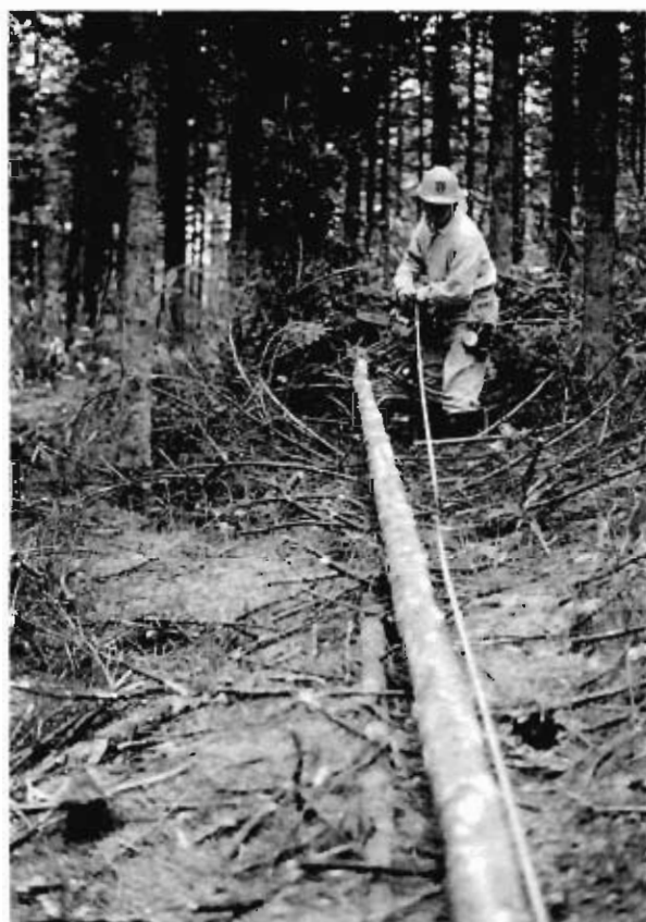
写真-8 林業用メジャーを使った測尺
