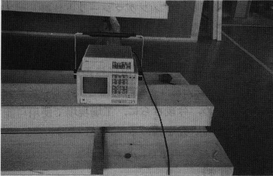
写真3 打撃音による縦振動法 (サウンドアナライザー)
