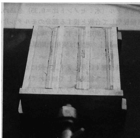
写真2 三連型枠によるセメント硬化不良試験
