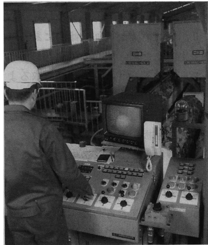
写真1 画像処理装置付きツイン 帯鋸盤による大割り作業
