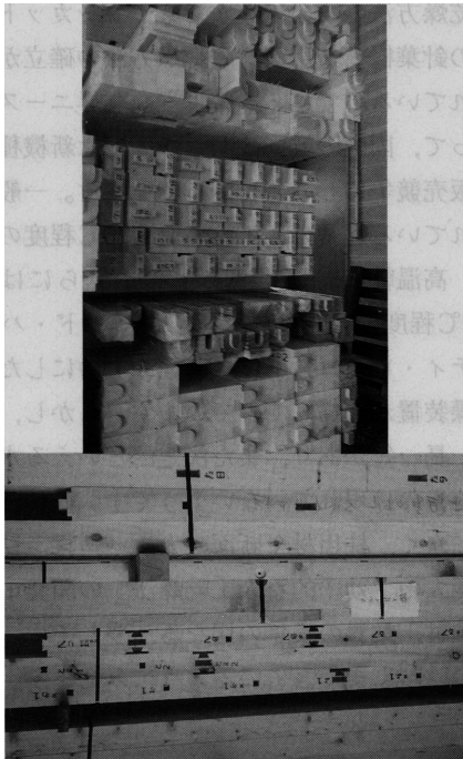
写真6 プレカット加工された軸組材 （上：木口面の状態，下：側面には使用部位が自動的に印字されている）
