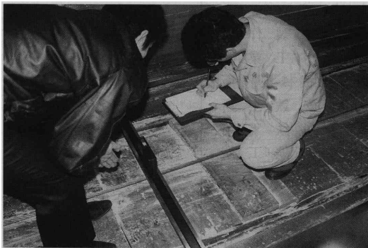
送材車レールの狂いの測定
