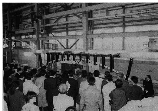
集成材アーチの載荷試験
