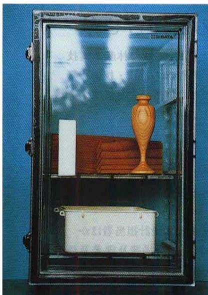
写真2 デンケータを用いた小型処理装置
