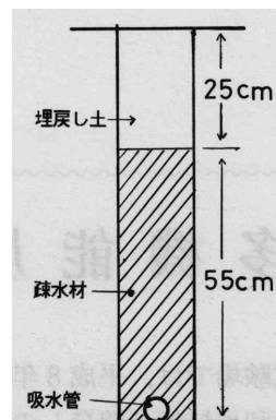
図1 暗渠の断面構造
