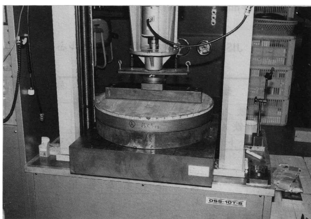
写真2 試験機にセットされたマンホールふた
