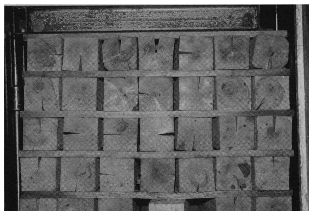
写真1 心持ち正角の乾燥後 (1・3段：背割り材, 2・4段：背割り無し)
