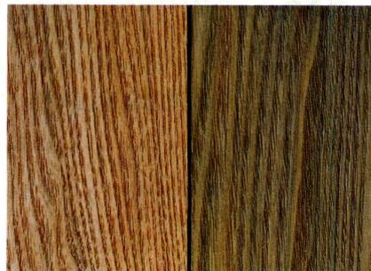
写真1 タモ無処理材(左)と埋もれ木調処理材(右)
