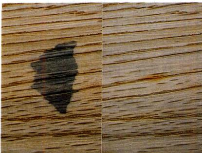
写真3 ナラ材の鉄汚染(左)と鉄汚染除去後(右)
