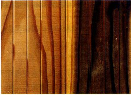
写真2 カラマツの無処理材(左)とアンモニア処理材(右)
