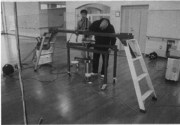
写真2 居住性床硬さの測定
