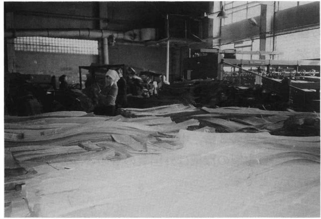
写真7 雑然と積み重ねられている乾燥突き板単板
