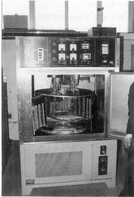
写真1 紫外線カーボンアーク灯式耐光性試験機の内部
