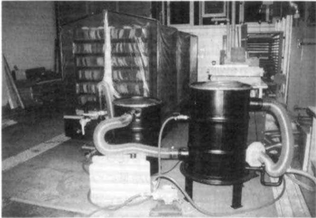
写真3 大型アンモニア処理装置
