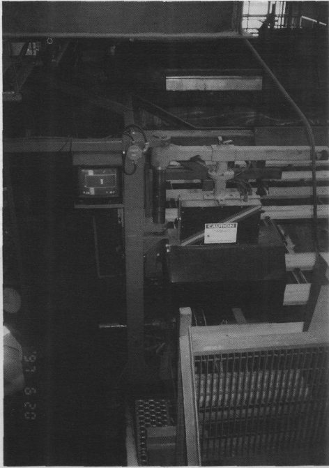
写真12 蛍光チョーク式画像処理による仕分け
