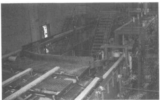
写真10 ER-Saha製材工場のメリーゴーランドライン
