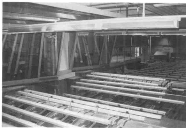
写真4 長さ決めラインと作業者ブース
