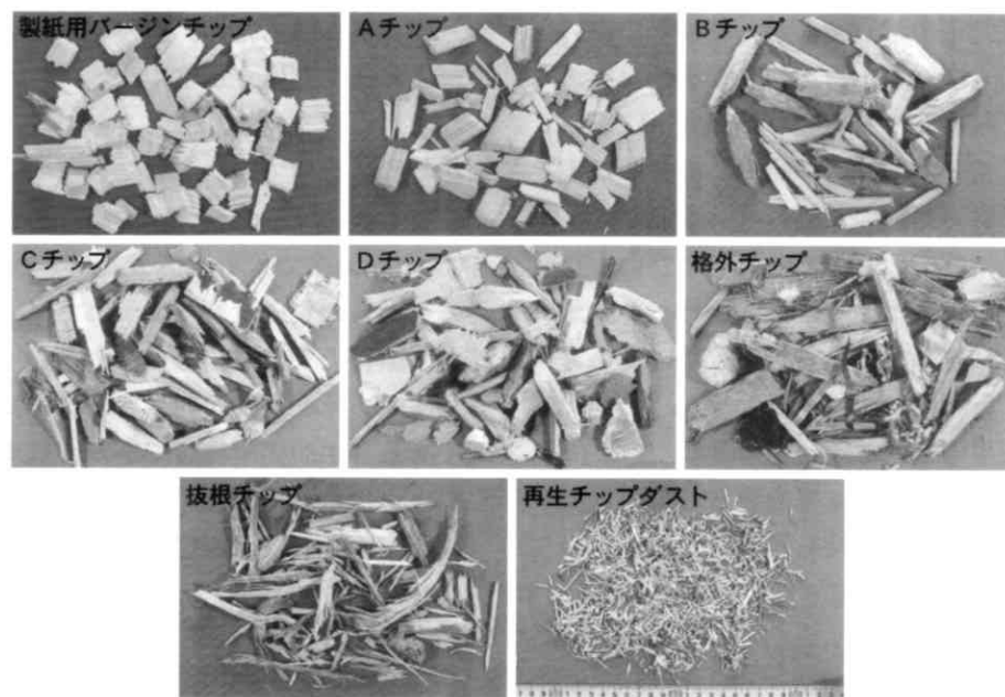
写真1 各種の再生チップ 注：写真の縮尺は共通 再生チップダストは篩目1mm下の分級品
