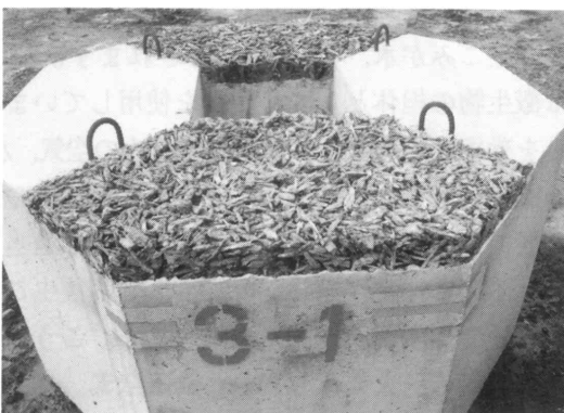
写真1 林産試験場が開発中の木質系海藻礁 上ノ国町の試験体
