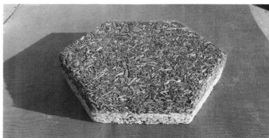
写真1 林産試験場で開発中の木質系舗装板
