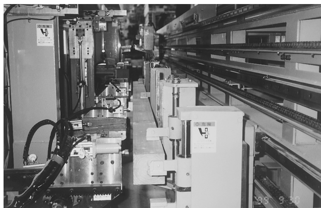
写真3 柱角すり直し装置 (斜め上より)
