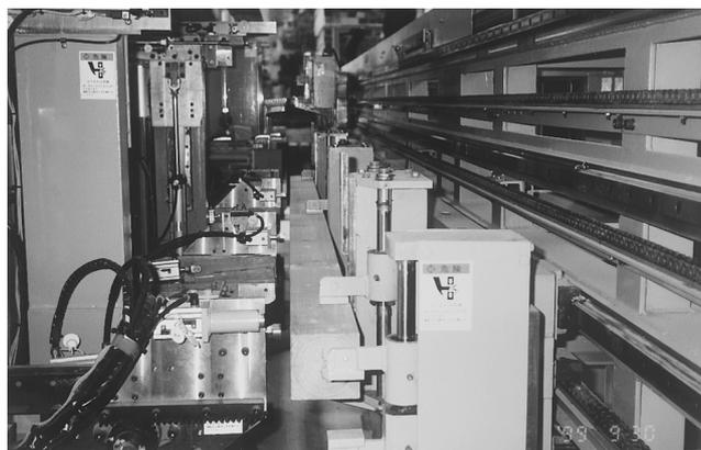
写真3 柱角すり直し装置 (斜め上より)
