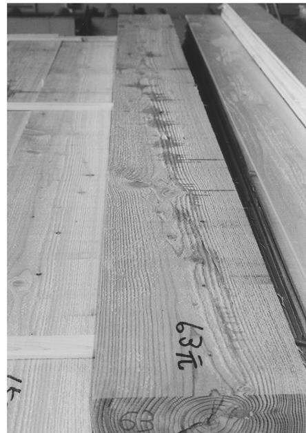
写真1 製材直後のカラマツ平角(梁せい300mmの心割れとヤニ)
