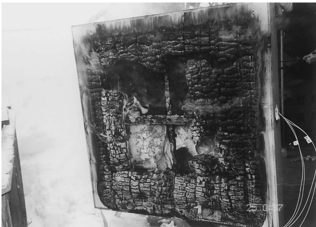
写真2 厚板木材を用いた木造外壁の耐火試験
