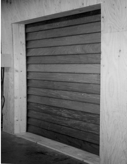
写真2 表面から見た試作シャッター(全閉状態)
