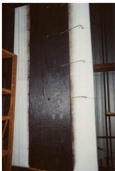
縮小規模での上方火炎伝播性実験 (カールトンプラザでの実験棟) 実大装置は3階建て外壁の火炎伝播性を評価する
