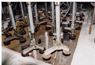
床の耐火性能を調べる水平炉 載荷用の治具が床一面に取り付けられる
