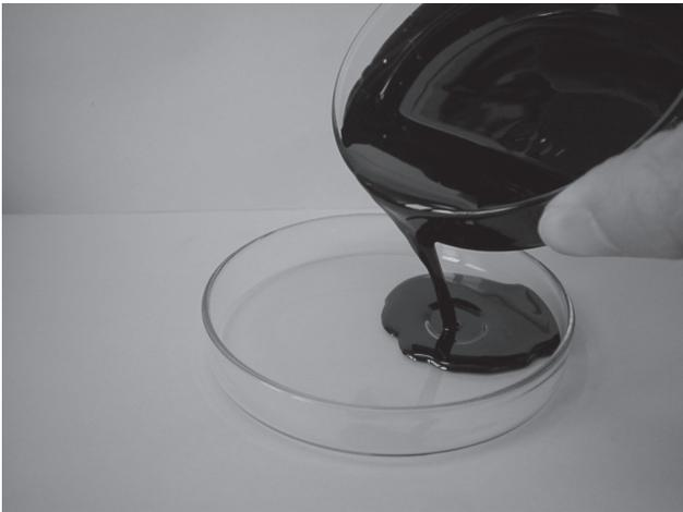
写真2 トドマツ材 275℃処理物液化処理後
