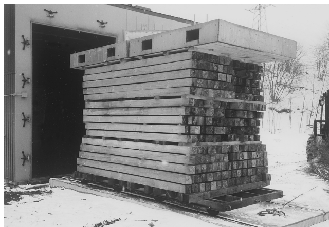
写真2 圧締用おもりを載せた高温乾燥
