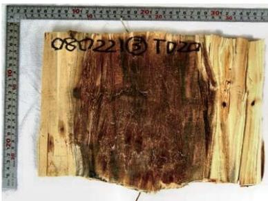
第3図 気乾材を原料とした熱圧処理材
