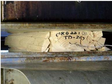
第2図 気乾材の圧縮時に生じた破壊
