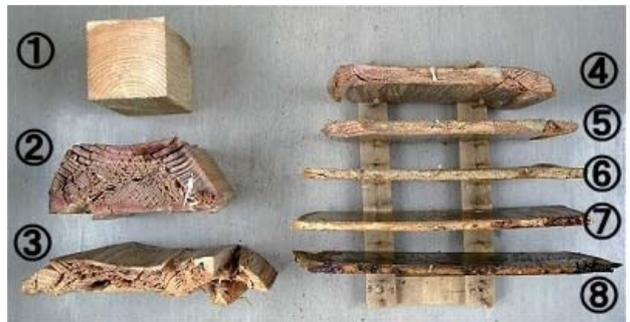
第 8 図 熱圧処理後の断面形状
