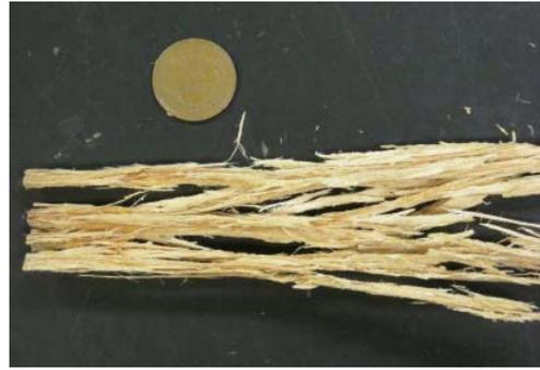
第 7 図 常温圧縮変形時の繊維束の例
