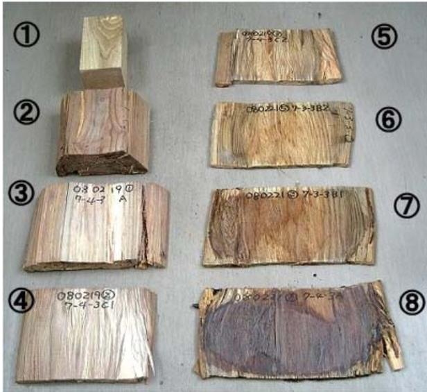
第9図 熱圧処理後の加熱面の状態
