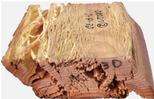
第 6 図 常温圧縮し幅拡張後に解圧した例
