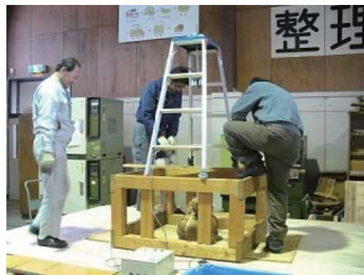
第 12 図 繰返し衝撃試験 Fig. 12. Test of cyclic impact force on floor.
