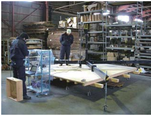
第 9 図 床の弾力性試験 Fig. 9. Test of floor elasticity.
