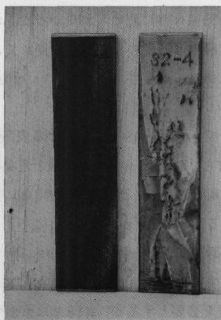
第2図 屋外暴露2年後の塗装MG処理木材(左)およびコントロール(右)の外観
