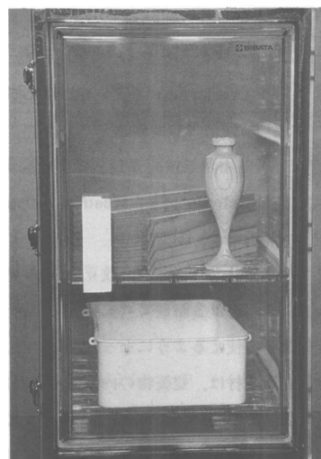
第2図 実験室的な処理装置 Fig.2. A lab-scale ammonia fuming chamber.
