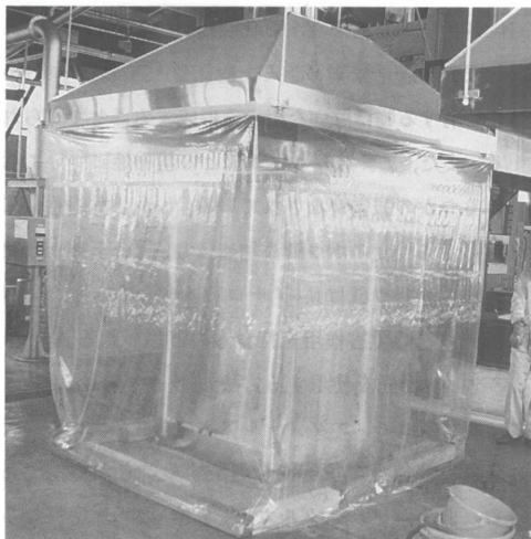
第3図 大型処理装置 Fig.3. Ammonia fuming equipment for large-scale production.
