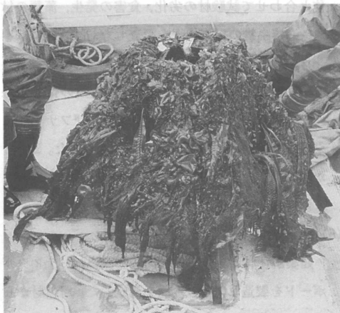
第1図 海中投入試験体(15か月経過時) Fig.1. Composite materials soaked in the sea for 15 months.
