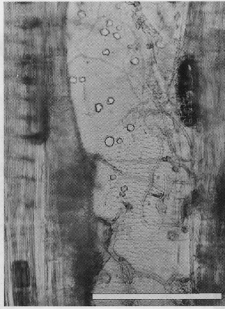
第3図 腐朽していると思われる部分(板目面)
