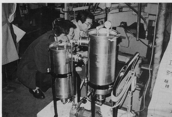
第7図 金属切削に使う水溶性切削液中の不純な油を除去するフィルター Fig. 7. The filter of impurities in the cooling liquid used in cutting of metal.
