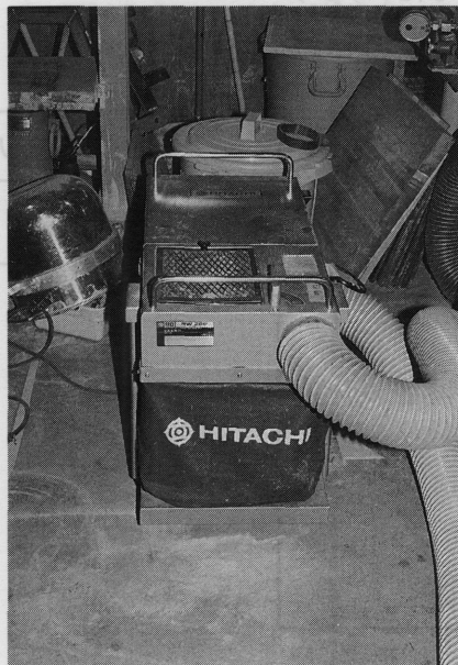
第5-3図 改良した製造工程で用いた装置 送風機（木工用集塵機）
