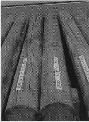
第18図 1か月屋外放置した円柱材の割れ発生状況
