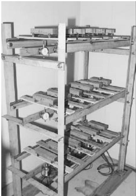
第1図 曲げクリープ試験風景
