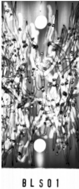
第9図 軟X線写真 - スギ無処理 (4か月経過) Fig. 9. Soft X-ray photograph of untreated Japanese cedar (4months exposure).
