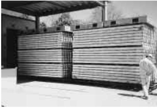
第2図 温湿度センサー取り付け後の積み材の様子 Fig. 2. Package piling attached temperature and humidity sensor.
