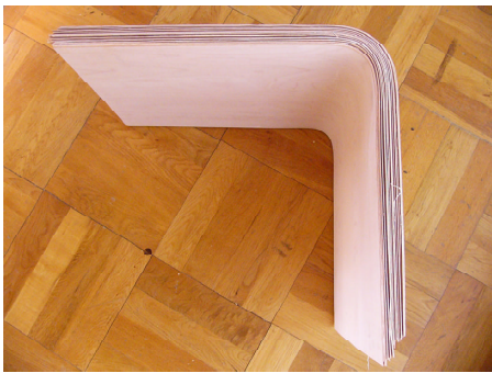
第4図 いすの脚に使う成形合板 Fig. 4. The molded plywood for legs of the chair.
