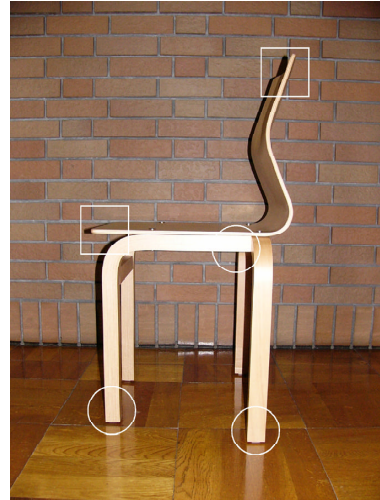
第7図 カットする箇所 ：脚， ：座と背もたれ Fig. 7. Cutting points. ：Legs, ：Seat and backrest
