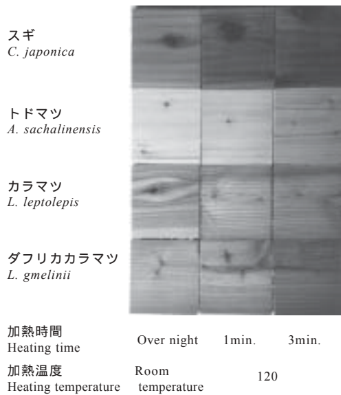
第5図 樹種別の変性酢酸ビニル樹脂系接着剤の加熱変色
